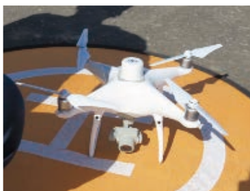
RTK 搭載ドローンによる高精度計測
